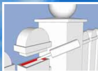
Verklebung und Abdichtung von PVC-hart-Elementen (z. B. Zäune)
