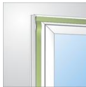
Bild 1: Eckauslegung bei der Fenstermontage
