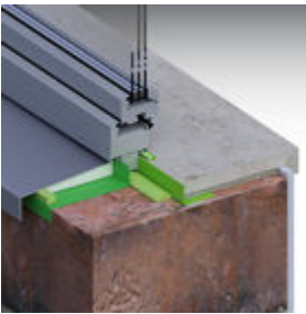
Verarbeitung des Fensteranschlusses mit FM230.
