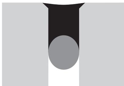
Durch die oberflächenbündige Fugenausbildung werden Stolpergefahren vermindert. Es entsteht eine einheitliche Fläche.
