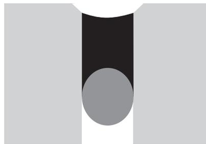
Durch die zurückgesetzte Fuge wird ein direkter Reifenkontakt mit dem Dichtstoff und somit eine mech. Verletzung verhindert.
