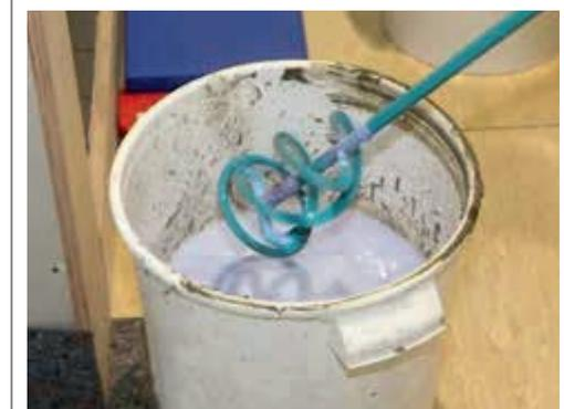
Einfaches reinigen des Rührers in Wasser
