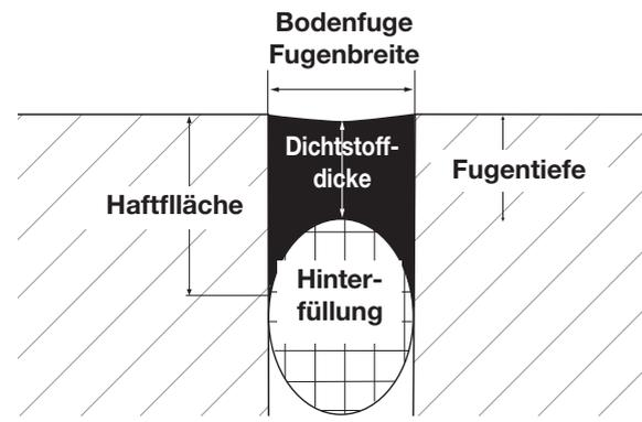
Bei Bodenfugen soll die Dichtstoffdicke etwa der Fugenbreite entsprechen. Die Begrenzung erfolgt durch die Hinterfüllung der Fuge mit einer geschlossenzelligen OTTOCORD PE-B2 Rundschnur, bzw. alternativ bei zu flachen Fugen mit einer PE-Folie.
