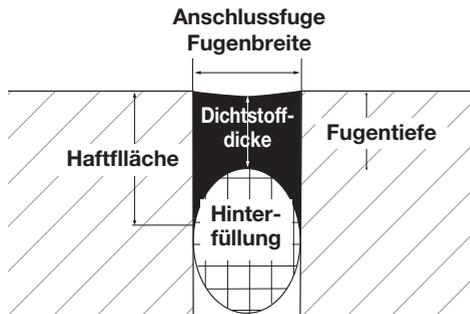
Bei Anschluss fugen sollte die Dichtstoffdicke ungefähr die Hälfte der Fugenbreite entsprechen.
