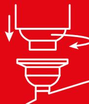
Das neue Click&Fix-Schnellwechselsystem: Einfach mit 1/4-Umdrehung die Dose auf die Pistole geklickt.
