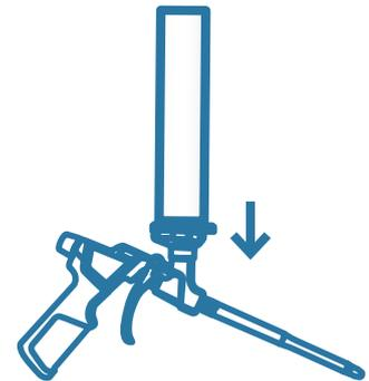
**Beim Füllen und Dämmen der Fuge sollte die MF 167 Dose möglichst mit Ventil nach unten gehalten werden.**
